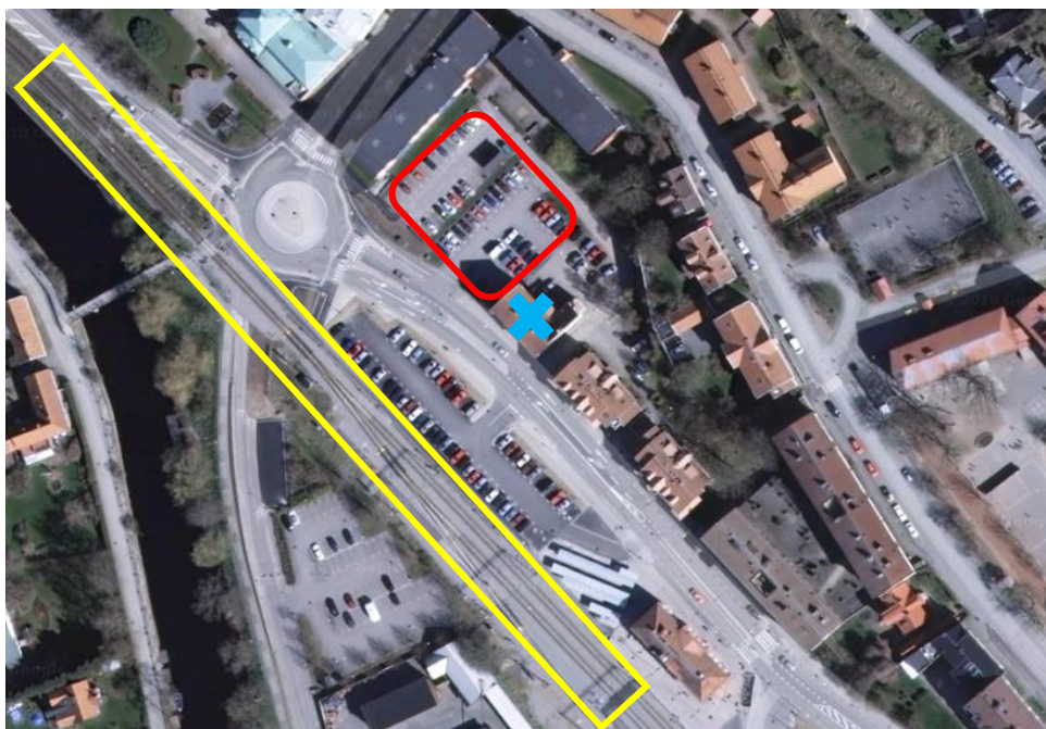
Figur 1: Satellitbild över Kv. Gertrud. Nybyggnation planerad i röd markering. Blått kryss indikerar byggnad där vibrationer mättes: Gertrud 24. Gult indikerar vibrationskälla (järnväg).
