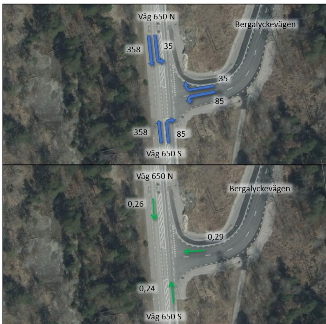
Figur 6. Trafikflöden och belastningsgrader i maxtimmen med trafiken för år 2040 i korsningen väg 650 / Bergalyckevägen.
