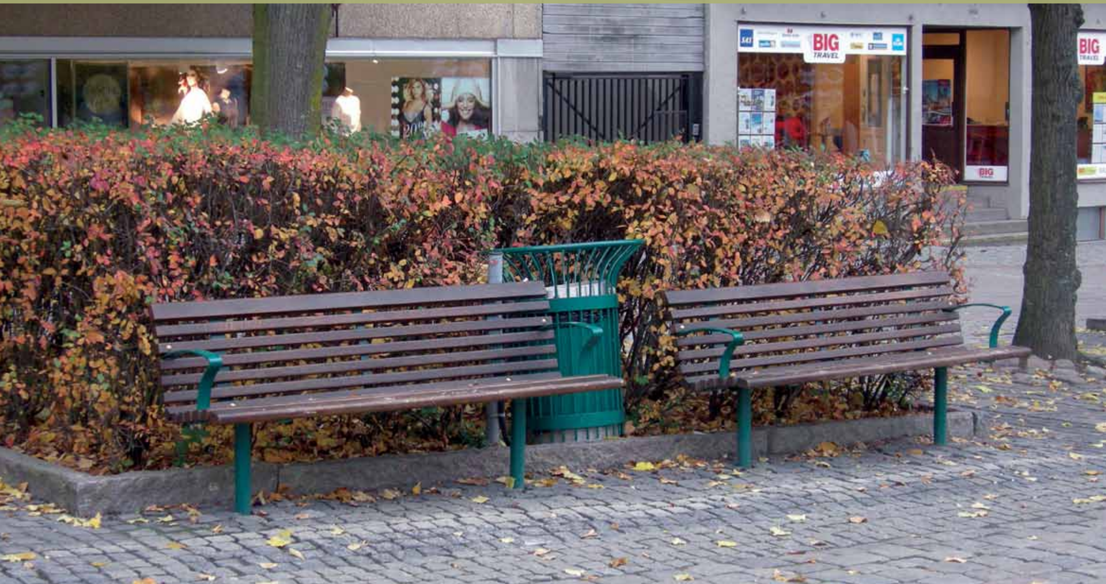
Bänkar och soffor skall ha Ronnebygröna stativ i metall och rygg- och sitttytor i oljat naturfärgat trä. Här bänken Ribb (Slottsbro).
